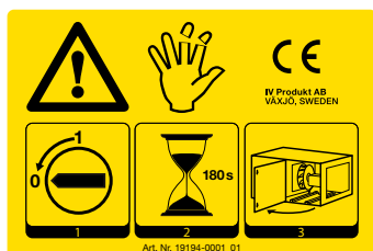
Beispiel: CE-Kennzeichnung für ein Lüftungsgerät
