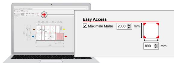
Im Produktwahlprogramm IV Produkt Designer können die gewünschten maximalen Modulabmessungen für die Geräte des Projekts angegeben werden. Das Programm teilt das Gerät automatisch in kleinere Modulteile auf, die nach Möglichkeit an die vorgegebenen Maße angepasst werden.
