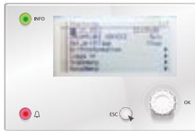
В дисплее ручного терминала Climatix, меню Главное меню / Агрегат / Холод, отображаются следующие параметры режима охлаждения:
