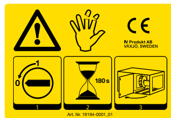
Eksempel på CE-mærke til ventilationsaggregat
