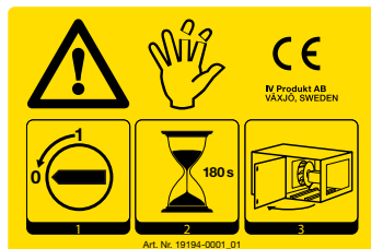
Exempel CE-skylt för luftbehandlingsaggregat
