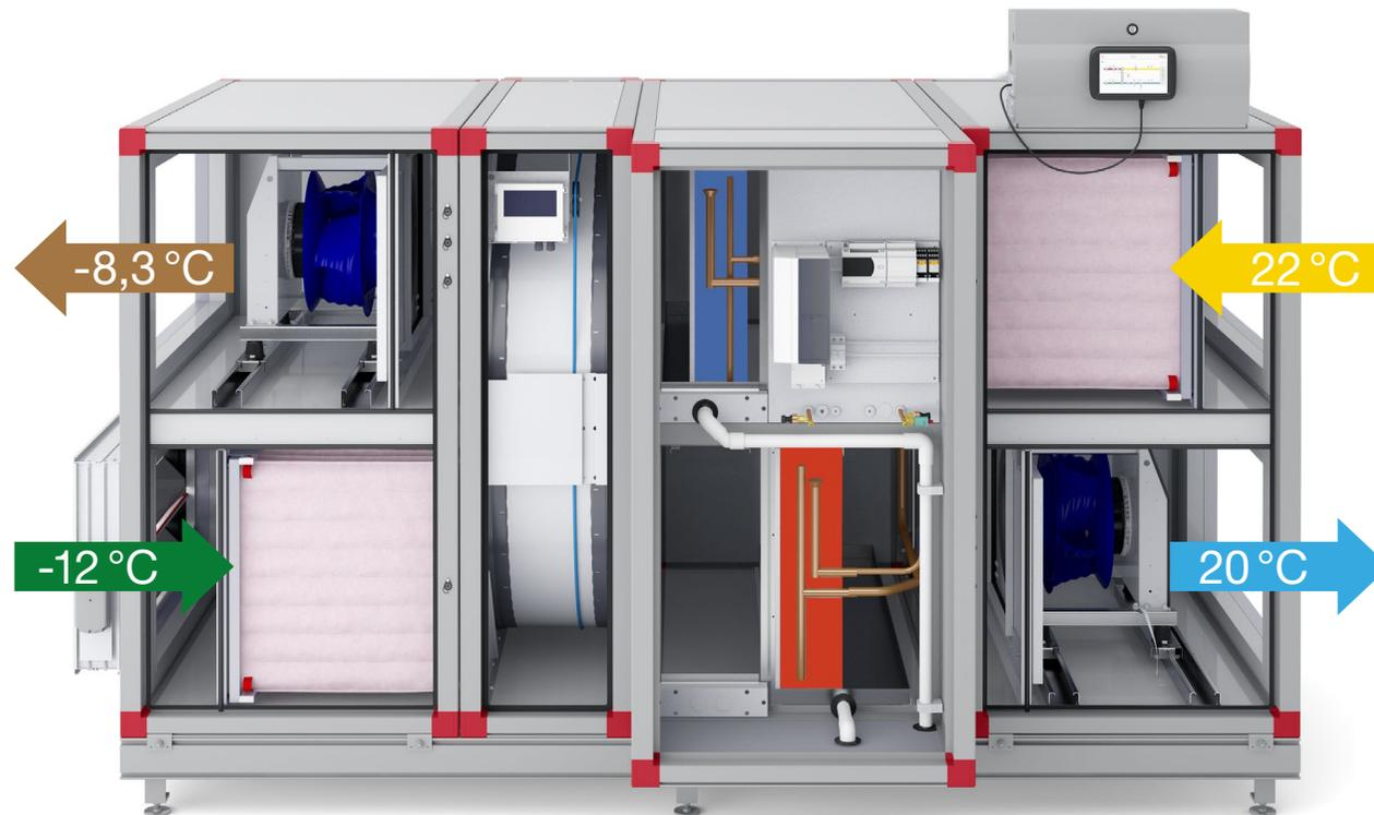
**An einem kalten Wintertag** mit einer Außentemperatur von minus 12 Grad wollen wir immer noch mit 20 Grad nachhelfen. Wenn wir den Kompressor im ThermoCooler HP mit 60 % fahren, schaffen wir das bei einer Ablufttemperatur von 22 Grad. In Kombination mit dem Rotor erhalten wir in diesem Beispiel einen Trockentemperaturwirkungsgrad von 88 %.
