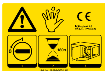
Eksempel på CE-mærke til ventilationsaggregat
