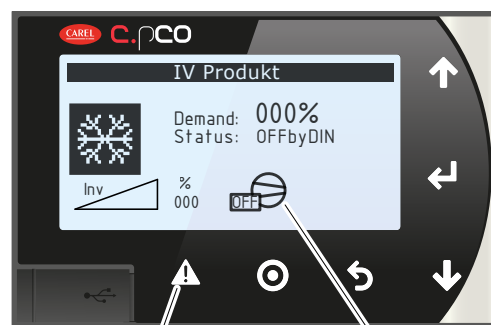
Alarmrückstellung Driftinformation kompressor
