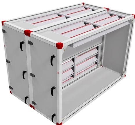
Смесительная секция EBB представляет собой модуль агрегата с тремя заслонками для смешивания отработанного выбросного, обратного и свежего наружного воздуха.
