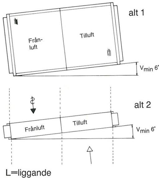
För HB med bredd (B) under 1500 mm och  $\Delta t \leq 50^\circ C$  kan installationen göras med  $V=0^\circ$ .
