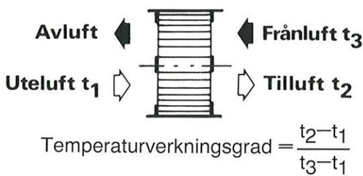
Här nedan visas en beräkningsgång för värmeåtervinnare RVA. Det är viktigt att märka att verkningsgraden ändras med förhållandet mellan olika luftflöden på till- och frånluft. Det mindre luftflödet får högre verkningsgrad och tvärt om.
