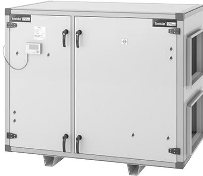
Envistar Compact wird als Einheitsgerät in verschiedenen Größen in Rechts- und Linksausführung produziert. Sämtliche Geräte sind mit Rotationswärmetauschern versehen und als Ausführung für die Außeninstallation erhältlich. Der Kanalanschluss der Geräte kann an den Breitseiten oder mit zwei der Anschlüsse nach oben erfolgen.
