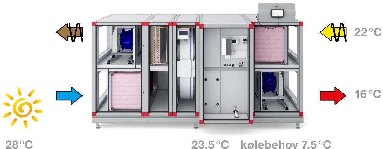
På en varm sommerdag med en udendørstemperatur på 28°C kan vi genvinde så meget af kulden i fraluften, at tilluftens afkøles til 23,5°C. I dette tilfælde behøver vi kun at afkøle luften 7,5°C i stedet for 12°C for at opnå en indblæsningstemperatur på 16°C.
