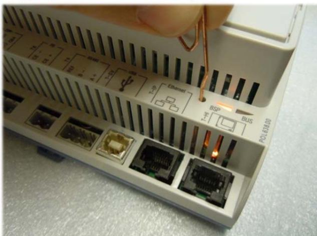
8. Hold knappen inne og slå på strømmen på DUC-en, slipp ikke knappen før BSP-lampen blinker grønt-rødt. Det kan ta noen sekunder før den begynner å blinke grønt-rødt, men hold knappen inne imens. Vent til BSP-lampen slukker helt eller lyser oransje. Dette tar ca. 30 sekunder.
