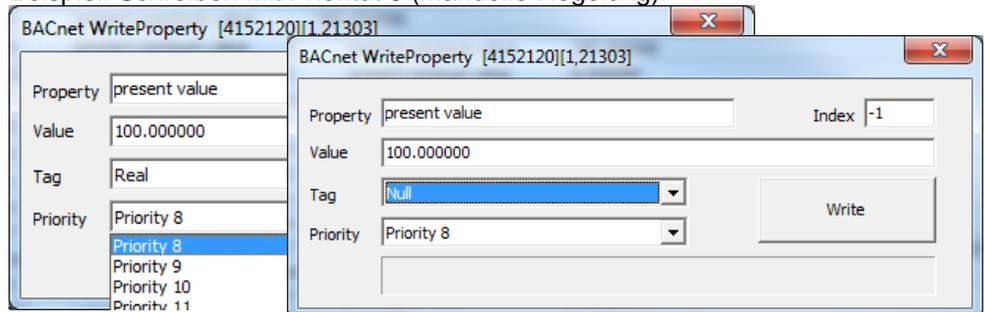
Einige Stufen werden durch die *Anwendung* verwendet und können nicht via BACnet überschrieben werden.
