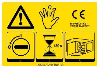
Eksempel på CE-skilt for luftbehandlingsaggregat
