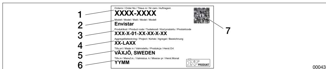
Figur: Eksempel på typeskilt på aggregat
