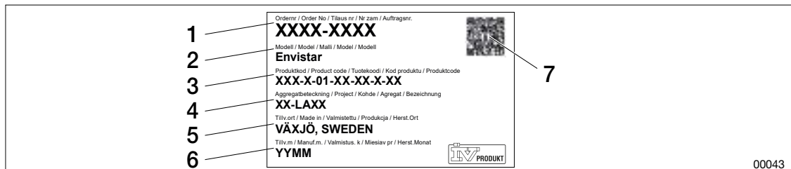
Figur: Eksempel på typeskilt på agregat
