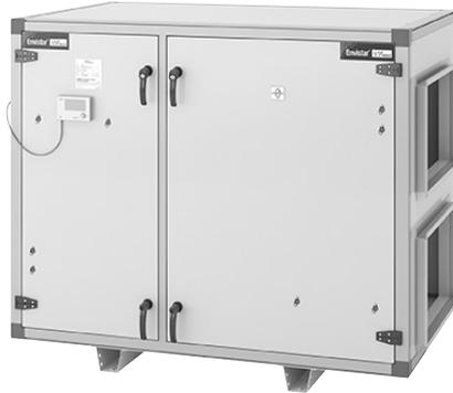
Envistar Compact wird als Einheitsaggregat in verschiedenen Größen in Rechts- und Linksausführung produziert. Sämtliche Geräte sind mit rotierenden Wärmetauschern versehen und als Ausführung für die Außeninstallation erhältlich. Der Kanalanschluss der Geräte kann an den Breitseiten oder mit zwei der Anschlüsse nach oben erfolgen.
