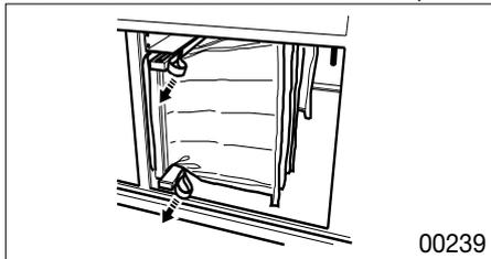
4. Lassen Sie die Griffe los und greifen Sie nach dem Filterrahmen.
