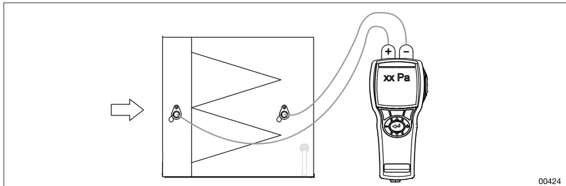
Abbildung: Druckverlust an den Filtern überprüfen
