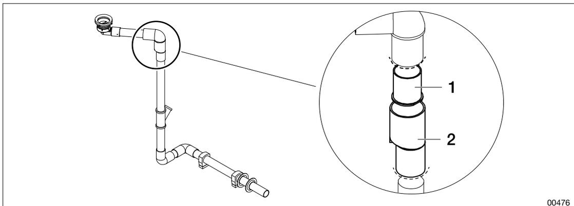
Abbildung: Membrankassette in der Rohrleitung
