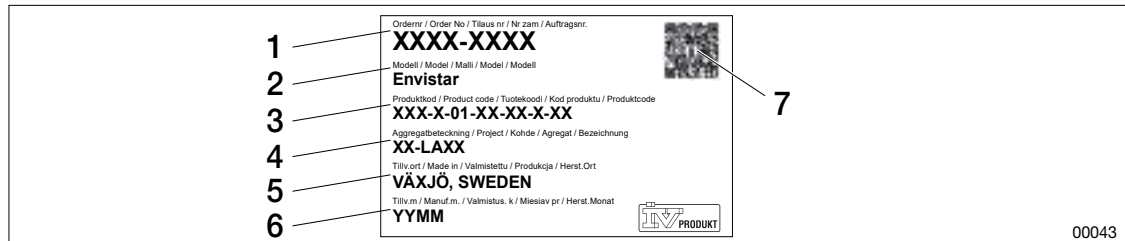
Ilustracja: Przykładowe zdjęcie Tabliczka znamionowa centrali
