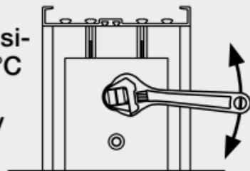
Заслонка монтируется в положении Закрыто. Крепление к воздуховоду обычно PG slip-зажимами.
