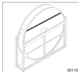
10. Anbring kabinetet så højt og så tæt på rotoren som muligt, og løft kabinetet på plads over rotoren med hjælp fra fire personer, som løfter i hvert deres hjørne.
