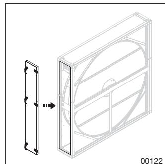
20. Skub rotoren på plads på stativet, og skub den sammen med den tilstødende del.
