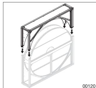
11. For størrelse 360-600: Nit kabinetets over- og underdel fast med popnitter ved dækpladens samlinger på inspektionssiden. For de øvrige størrelser: Gå til næste trin.
