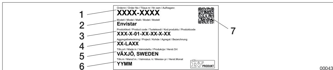
Figur: Eksempel på typeskilt på aggregat
