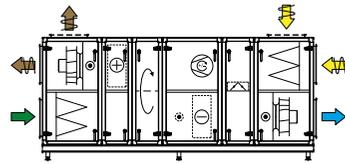
Komb. 6 Kältemaschine mit Kälterückgewinnung und Umluftteil
