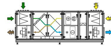
Komb. 10 Gegenstromwärmetauscher, Kältemaschine, Umluftteil
