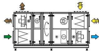
Komb. 3 Kältemaschine mit Kälterückgewinnung
