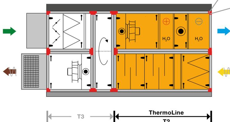
Bei Geräten im Freien führen vor allem die Zu- und Abluftteile zu Wärmeverlusten. Hier stellt die Auswahl dieser Teile in der Ausführung **ThermoLine – T2** die energie- und kosteneffizienteste Lösung dar.
