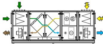
Komb. 8 Gegenstromwärmetauscher und Kältemaschine
