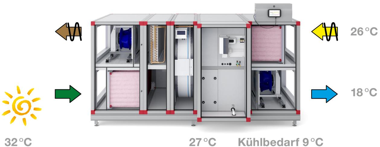
An einem warmen Sommertag mit einer Außentemperatur von 32 °C können wir so viel Kälte aus der Abluft zurückgewinnen, dass die Zuluft auf 27 °C abgesenkt wird. In einem solchen Fall braucht die Luft nur um 9 °C statt um 14 °C abgekühlt zu werden, um eine Einblastemperatur von 18 °C zu erreichen.
