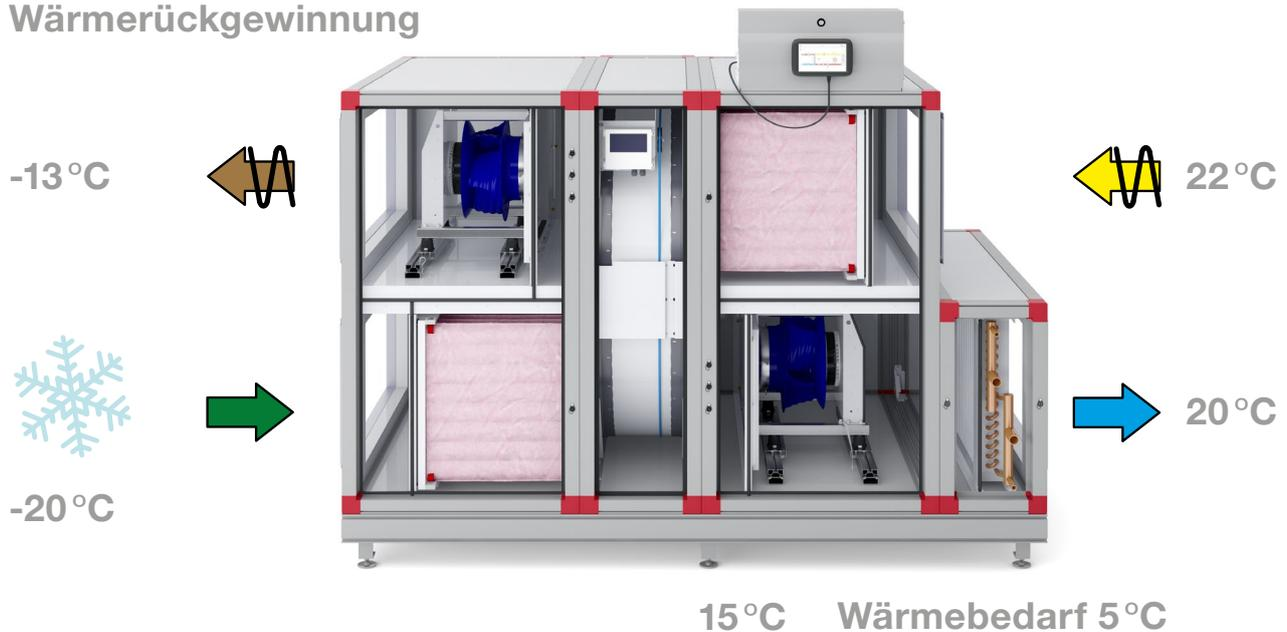
An kalten Wintertagen mit Außentemperaturen von  $-20\text{ °C}$  können wir mit Hilfe eines rotierenden Wärmetauschers so viel Wärme aus der Abluft zurückgewinnen, dass die Zuluft auf  $15\text{ °C}$  vorgewärmt wird. In einem solchen Fall braucht die Luft nur um  $5\text{ °C}$  statt um  $40\text{ °C}$  erwärmt zu werden, um eine Einblastemperatur von  $20\text{ °C}$  zu erreichen.
