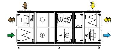
Komb. 14 Kreislaufverbundsystemteil, Kältem., Umluftteil
