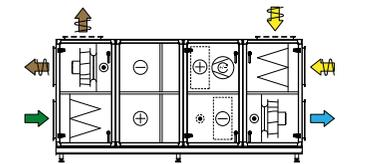
Komb. 12 Kreislaufverbundsystemteil und Kältemaschine
