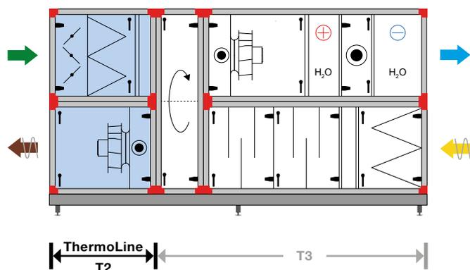
Ein großer Vorteil der Gehäusekonstruktion besteht darin, dass bei bestimmten Teilen eines Geräts verschiedene Gehäuseklassen gewählt werden können. Wenn wir beispielsweise Zu- und Abluftteil für ein Innengerät in der Baureihe **ThermoLine – T2** wählen, haben wir damit die energie- und kosteneffizienteste Lösung.
