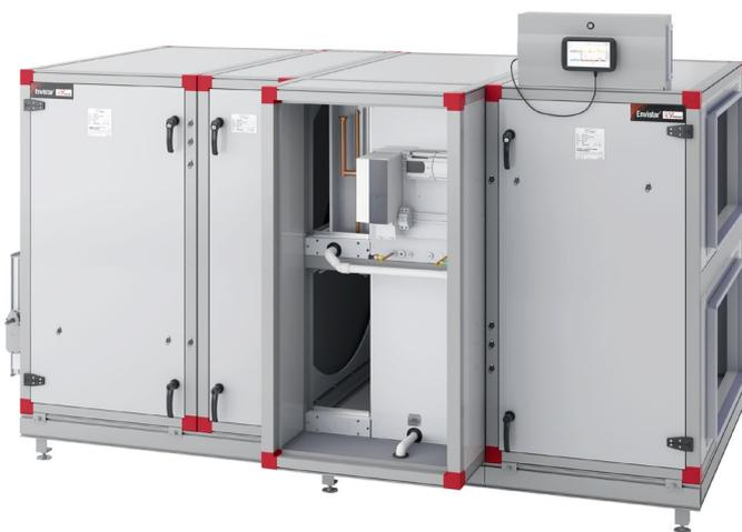
Die Scrollkompressoren verfügen über Permanentmagnetmotoren und sind drehzahlgesteuert. Das Expansionsventil ist elektronisch und die Abmessungen sind für eine einfachere Einbringung ins Gebäude optimiert.
