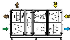
Komb. 2 Rotor und Kältemaschine
