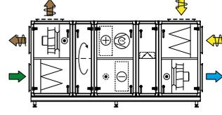
Komb. 5 Rotor, Kältemaschine und Umluftteil
