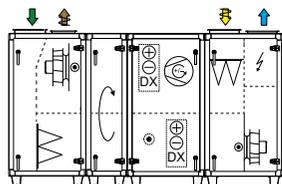
Rotor und Reversible Wärmepumpe
