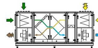
Komb. 9 Gegenstromwärmetauscher und Umluftteil
