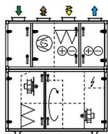
Rotor und Reversible Wärmepumpe
