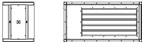
Требуется 1 двигатель либо ручной привод (ось 12x12 мм).
