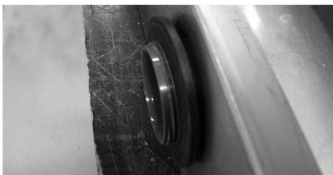
3. Установите стопорное кольцо и затяните его вручную.
