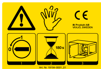
Exempel CE-skylt för luftbehandlingsaggregat
