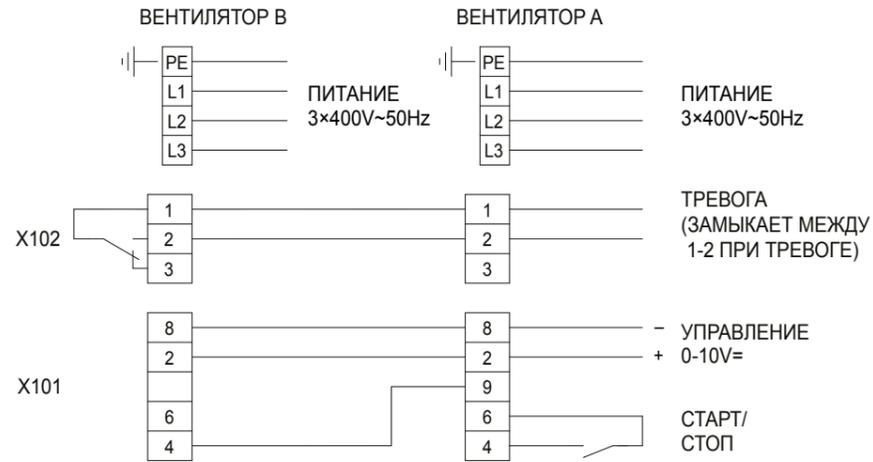
Со встроенным преобраз. частоты FCM-300.
