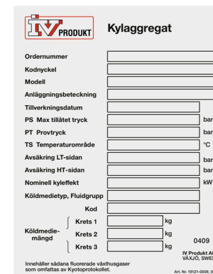
Пример CE-маркировки холодильного агрегата
