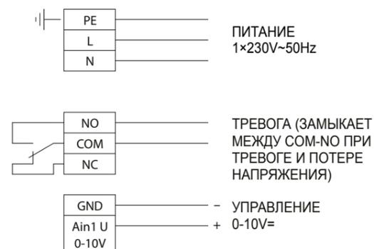
Двигатель вкл/выкл. от сигнала 0,5V.
