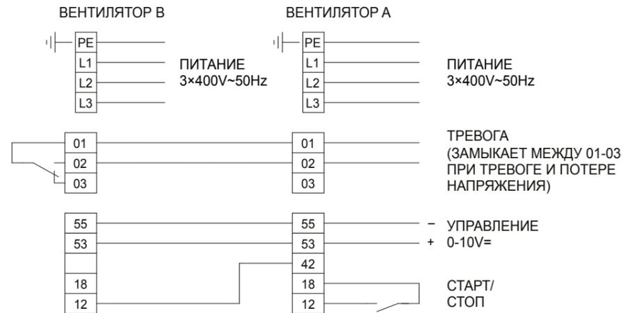
Со встроенным преобраз. частоты FCM-300.
