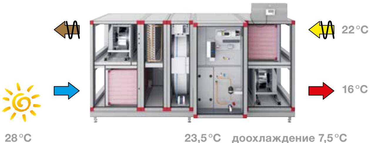
Жарким летним днем Вы можете, с помощью роторного утилизатора холода, вернуть значительное количество холода из воздуха помещения. В данном примере мы доохлаждаем воздух после ротора всего на 7,5 градусов (от +23,5°C до +16°C), вместо 12 градусов (от +28°C до +16°C).
