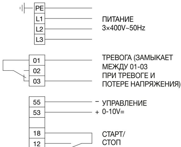
Со встроенным преобразов. частоты FCM-106
