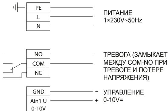
Двигатель вкл/выкл. от сигнала 0,5V.
