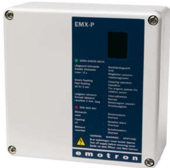
Emotron EMX-P представляет собой небольшой гибкий блок управления скоростью вращения малыми роторными утилизаторами энергии и предназначен для подключения двигателя (25 W либо 40 W, max 0,7 A) от Panasonic или Oriental, с редуктором и тахометром. Блок вместе с двигателем монтируется в корпус секции утилизатора энергии вентилатора.
