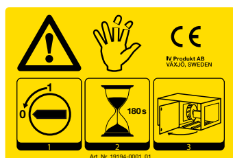
Eksempel på CE-mærke til ventilationsaggregat
